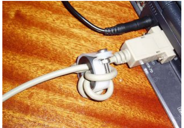
Dieser Ferritring verhindert sicher störende HF-Einkopplungen in den Laptop.
