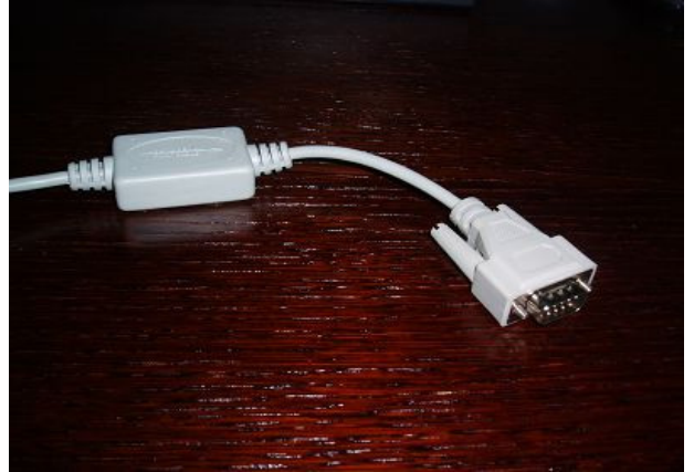
Das von mir verwendete Adapterkabel mit Seriell/USB-Wandler .
