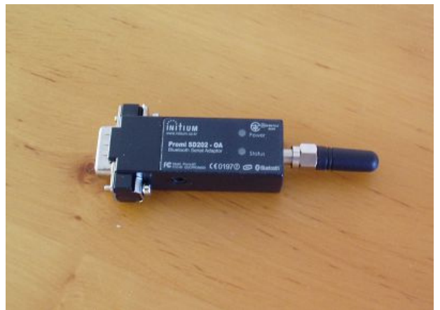
Bluetooth Dongle zum Anschluss an den 9-poligen Sub-D Stecker einer seriellen Schnittstelle.
