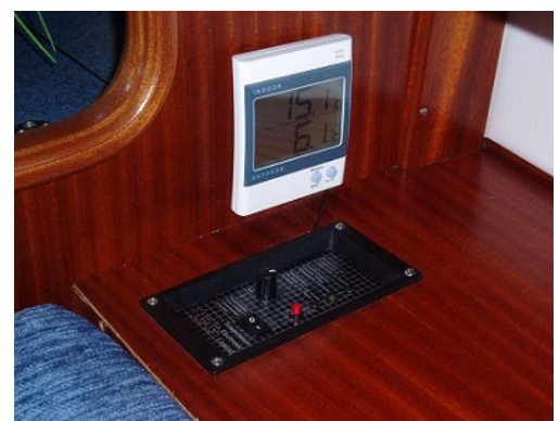
Die Steuerelektronik sorgt dafür, dass der Kompressor der Kühlbox
