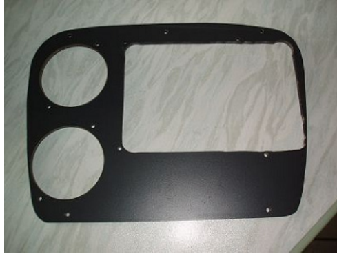
Das ist die neue Abdeckplatte mit den Ausschnitten für die Geräte.
