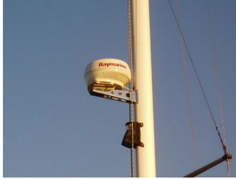
Der 2" Radarscanner ist mit einer Edalsthalterung am Mast angebracht.
