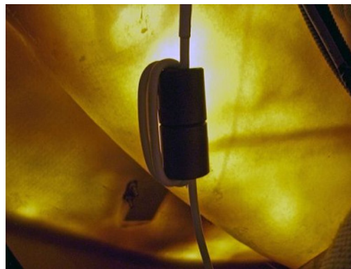
Eine solche Hochfrequenzdrossel in der Zuleitung des RTE ist natürlich nur dann erforderlich, wenn man wie ich meint das Kabel unbedingt direkt neben der Antenne des KW-Senders verlegen zu müssen.
