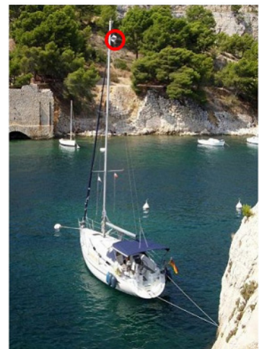
Die Befestigung des Reflektors oben am Achterstag war keine gute Idee. Sie löste sich in einem Wintersturm. Als Folge rieb sich die Dirk an den scharfen Kanten des Reflektors durch - ein teurer Spaß!
