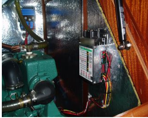
Den Sterlingregler schraubt man in der Nähe der Lichtmaschine an eine Schottwand.
