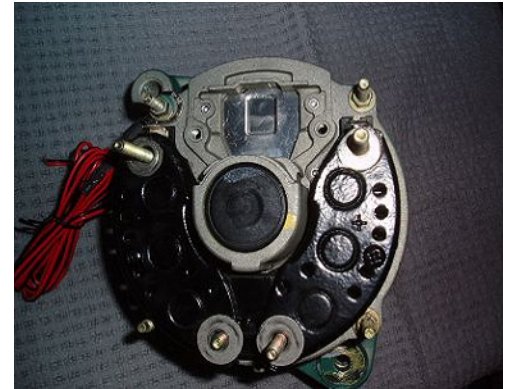
Hier ist bei geöffnetem Deckel der Regler ausgebaut und der Temperaturfühler bereits unter der Gehäuseschraube oben links befestigt.
