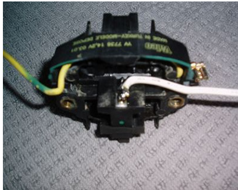
Die vordere der beiden Kohlen ist der gesuchte Anschluss DF an den ein ca. 20cm langes Stück Litze angelötet wird.
