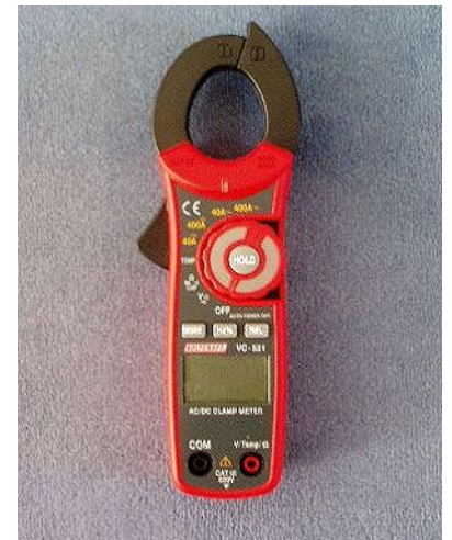
Das Vielfachmessinstrument VC-521 von Voltcraft hat sich bei mir bei der Fehlersuche in der Bordelektrik bewährt. Als Zangenamperemeter misst es Ströme bis 400 A.
