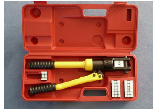
Mit einer solchen hydraulischen Presse quetsche ich Kabelschuhe auf Kabel von 10, 16, 25, 35, 50, 75, 95 und 120 mm 2 . Sicher keine Lösung für Profis aber für Gelegenheitspresser m. E. ideal.
