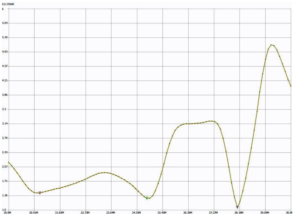
Bild 11 SWR im Bereich 20 – 30 MHz mit Markern bei 21,1, 24,9 und 28,1 Mhz
